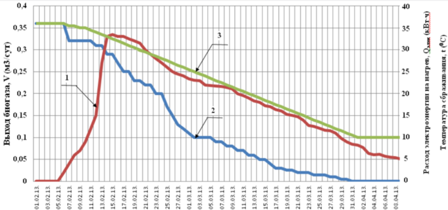
Рисунок 4.13 – Результаты опыта по адаптации мезофильных метаногенных микроорганизмов к психрофильным условиям в метантенке биогазовой установки: 1 – выход биогаза, V_B , м 3 /сут; 2 – расход электроэнергии на нагрев сбраживаемого субстрата, Q_{ЭД} , кВт/сут; 3 – температура сбраживания в метантенке, t_{СБР} , °C.
