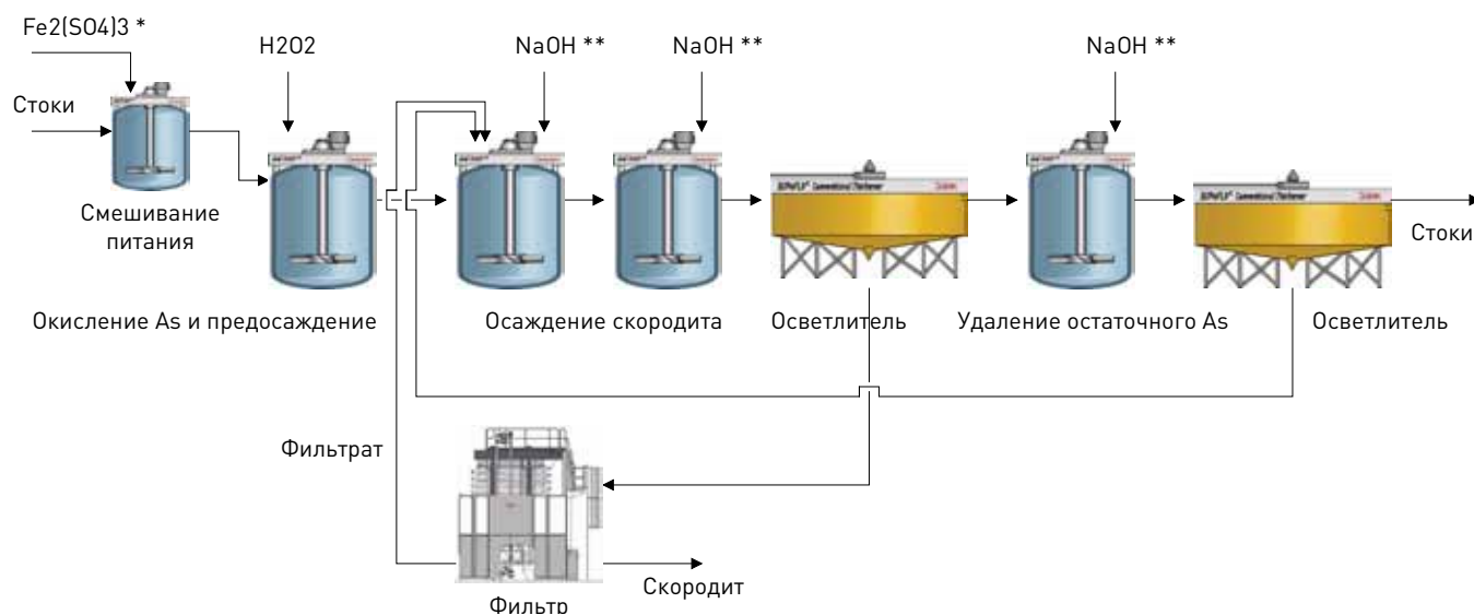
Пример решения для осаждения мышьяка в виде скородита
